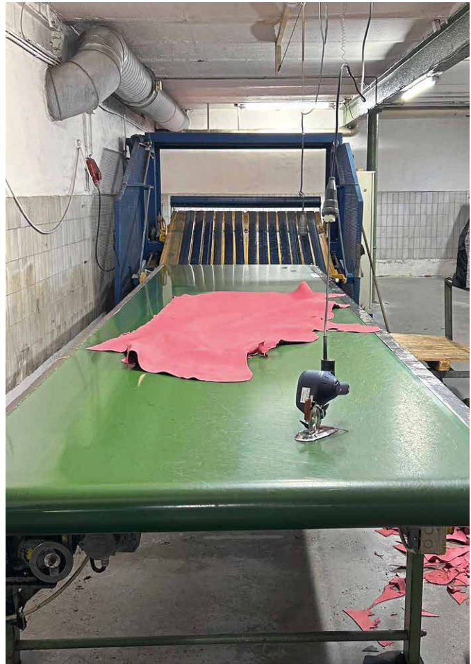
Abstehendes wird mit einem Rundmesser per Hand abgeschnitten.
