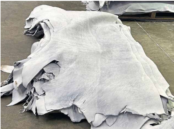
Wet Blue: Das blaue Nass ist feuchtes chromgegerbtes Leder.
